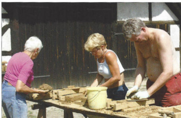
Abb. von oben nach unten: Anfängerfehler: Darüber sind wir hinweg Das Entenhaus von 2007, links mit Stroh, rechts mit Reet gedeckt Lehmziegel werden in Formen „gebacken“... ... und anschließend an der Luft getrocknet
