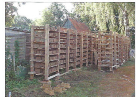
Gestell zum Trocknen der Lehmbausteine – im Hintergrund die „Trocknungshalle“
