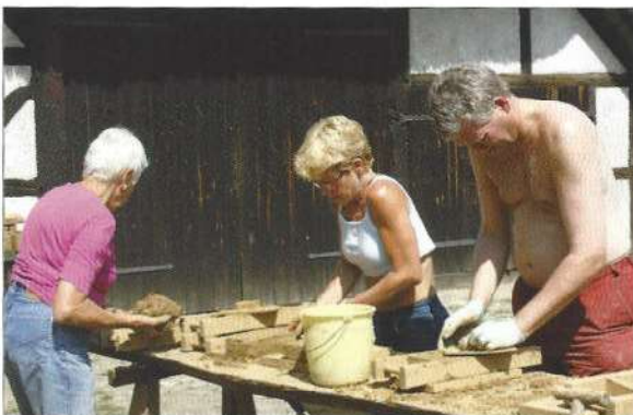
Abb. von oben nach unten: Anfängerfehler: Darüber sind wir hinweg Das Entenhaus von 2007, links mit Stroh, rechts mit Reet gedeckt Lehmziegel werden in Formen „gebacken“... ... und anschließend an der Luft getrocknet
